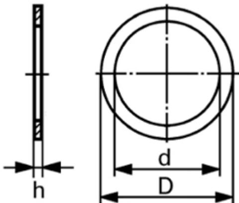
**DIN 7603 Dichtringe für Rohrverschraubungen und Verschlußschrauben, A= Flachdichtring**
